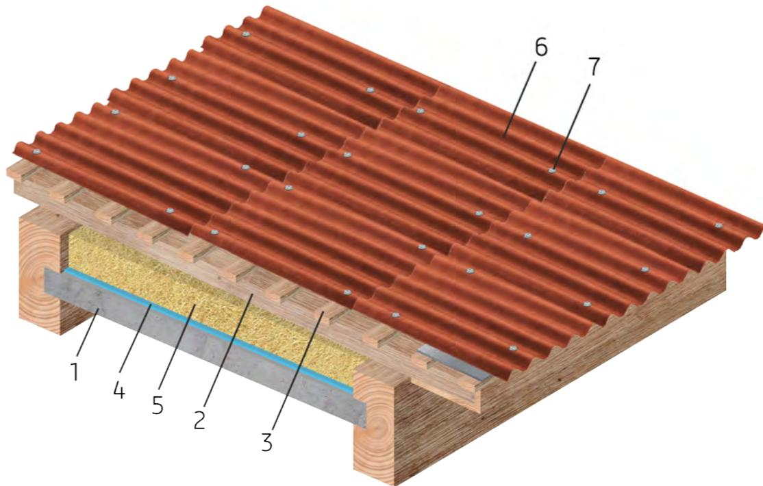
Рис. 99. Скатная кровля конструкции «Урал-2»\*
