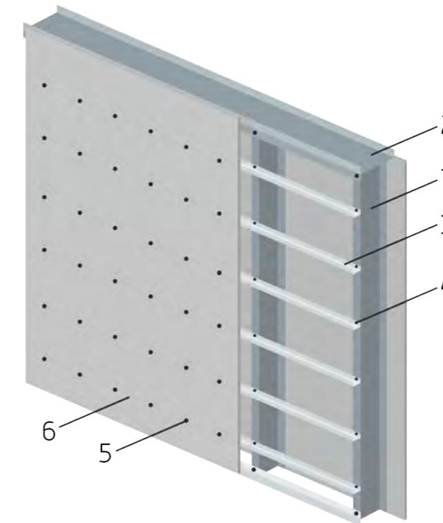
Рис. 127. Несъемная опалубка на металлическом каркасе
