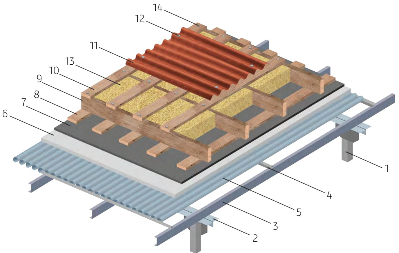
Рис. 132. Составное перекрытие зданий и сооружений с применением труб
