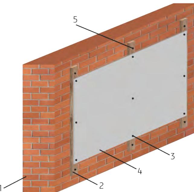
Рис. 113. Фасад кирпичного здания из плоских хризотилцементных листов
