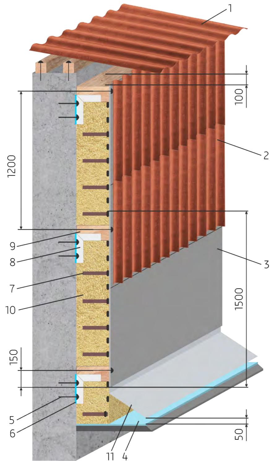
Рис. 112. Утепленный вентилируемый фасад конструкции «Урал-1»
