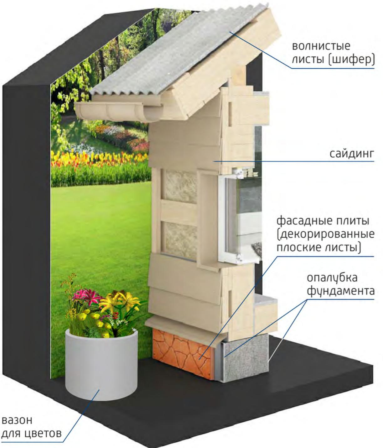
Рис. 25. Применение ХЦ изделий для внешних элементов дома
