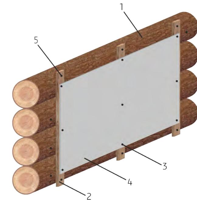
Рис. 116. Фасад деревянного здания из плоских хризотилцементных листов
