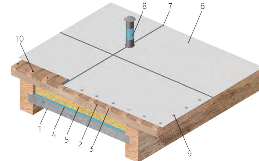
Рис. 100. Скатная кровля конструкции «Урал-3»\*
