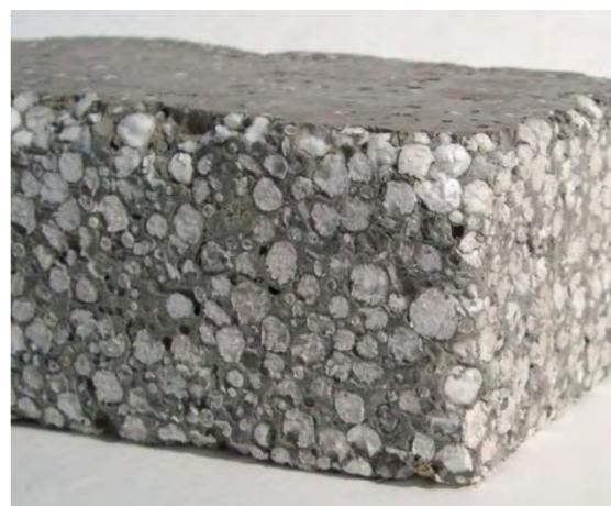
Рис. 123. Теплоизоляционный бетон
