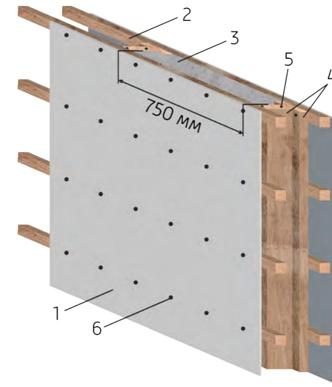
Рис. 130. Несъемная опалубка на деревянном каркасе
